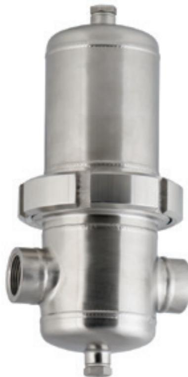
Nelle industrie di processo con un alto rischio di corrosione dei componenti degli impianti dell'aria compressa, la gamma di filtri di processo Pneumatech FP 1-18 offre la soluzione giusta. L'alloggiamento del filtro è realizzato in acciaio inox di grado 1,4301. La superficie è stata levigata con avanzate tecniche meccaniche e di elettrolucidatura fino a un livello di Ra 1,6. Per evitare la contaminazione da microrganismi tra la testa del filtro
